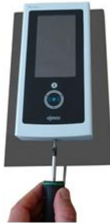
Endgültige Befestigung des Infoterminals
