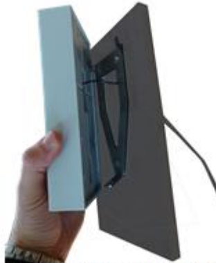
Anbringen des Infoterminals auf die Halterung
