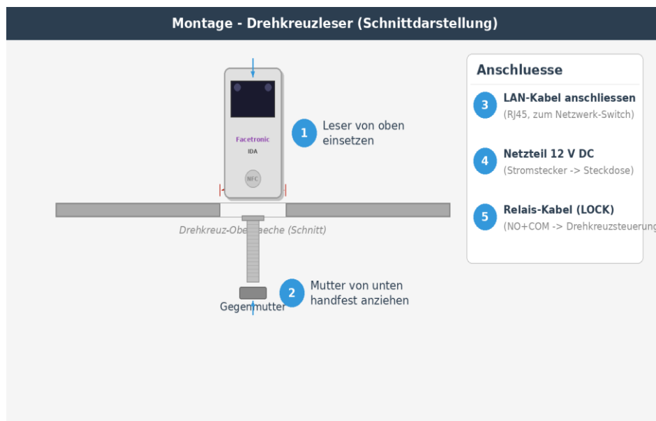
Abb. 4: Montage des Drehkreuzlesers
